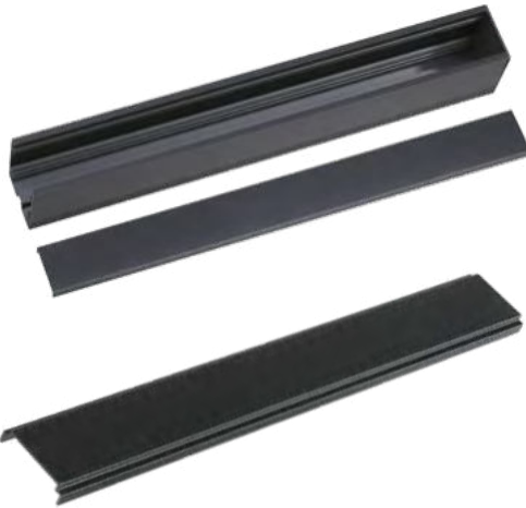
135031 IP 20 Коробка для драйверов В комплекте соединители Черный Алюминий (В*Ш*Д) 62,8*50,6*300 мм
