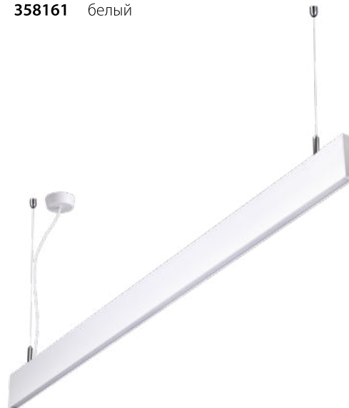
358160 IP 20 358161 Светильник подвесной светодиодный В комплекте: сетевой кабель (длина 1.5 метра) с декоративной чашей, подвесной комплект (длина тросов 1.5 метра), соединитель прямой, пластина для укрепления соединений Алюминий 30 Вт вниз + 10 Вт вверх 220-240 В 2336 Лм вниз + 904 Лм вверх 4000 К Цвет LED белый Угол рассеивания 100° (Д*Ш*В*) 1198*18.5*80 мм
