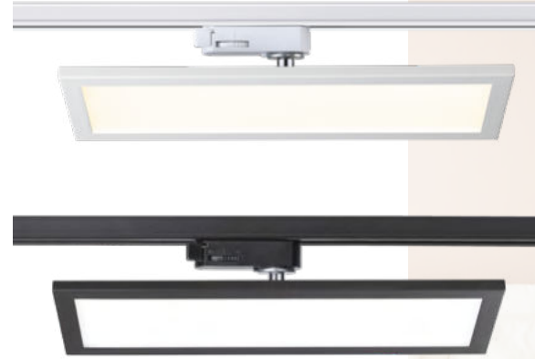
357988 IP 20 357989 Светильник однофазный трековый светодиодный Корпус – алюминий/ рассеиватель – пластик 20 Вт 100-240 В 1500 Лм 4000 К Цвет LED белый Угол поворота по горизонтали 350°, по вертикали 90° Угол рассеивания 120°
